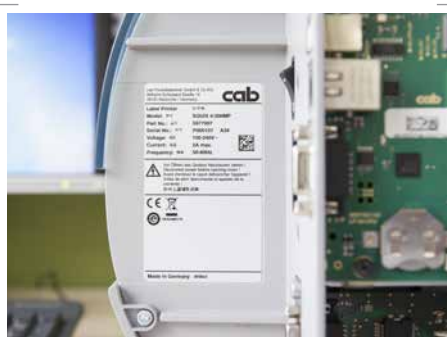
Identificación de placas de características
